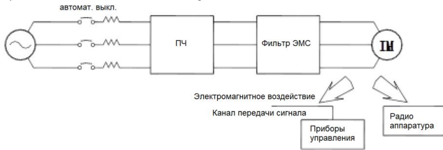
Рис.3 7 Установка фильтра помех на выходной стороне
